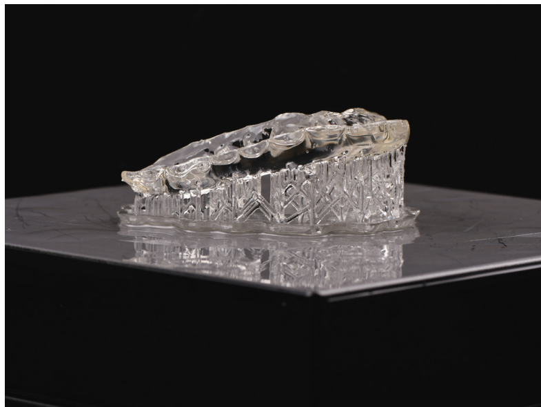
Obr. 1 Čerstvý výtisk okluzální dlahy s přítomnými podpurnými strukturami před post-processingem
