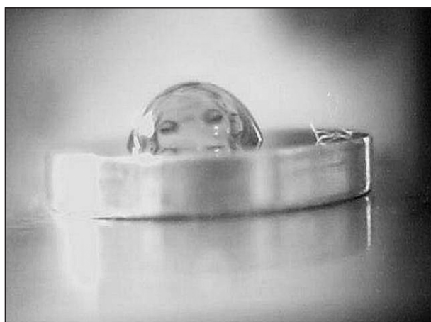
Obr. 3. Fotografie kapky destilované vody o objemu 10 \mu\text{l} před měřením kontaktního úhlu na vzorku titanové slitiny.
