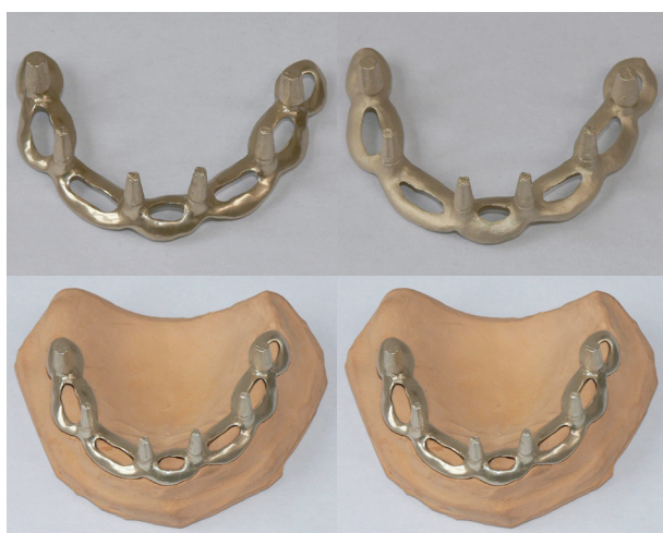
Obr. 2. Implantát povlakovaný vrstvou ZrN: (a) leštěný, (b) drsný.
