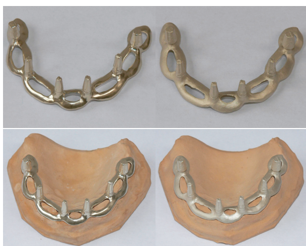
Obr. 3. Implantát povlakovaný multivrstvou Zr/ZrN: (a) leštěný, (b) drsný.
