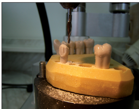
Obr. 16. Upevnění modelu, kalibrační zářezy frézou na vosk.
